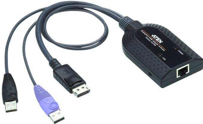
El cable adaptador KVM KA7189 conecta un switch KVM a los puertos de vídeo DisplayPort y USB del ordenador de destino.\* El KA7189 admite salida DisplayPort e incorpora dos puertos USB para conectar a un ordenador de destino para teclados y ratones, función Virtual Media y función de lector de Smart Card/CAC.\*\*
