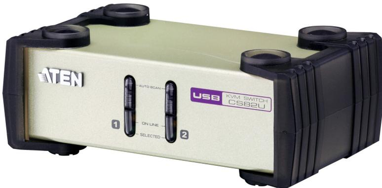
El hub KVM para PS/2-USB CS82U es una unidad de control de escritorio que permite a los usuarios de acceder a dos ordenadores desde una consola KVM (teclado y ratón USB o PS/2 y pantalla VGA). Además, el CS82U se basa en la nueva tecnología gráfica DynaSync™ de ATEN, que elimina los problemas que pueden surgir al arrancar los equipos, que optimiza la resolución en pantalla.
