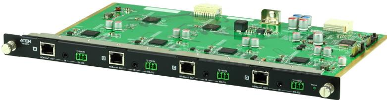
La tarjeta de salida HDBaseT de 4 puertos VM8514 ofrece una forma sencilla de redirigir 4 transmisores HDBaseT a 4 receptores HDBaseT y, en combinación con los switches de matriz modulares de ATEN, permite redirigir hasta 32 conexiones de entrada y 32 conexiones de salida HDBaseT.
