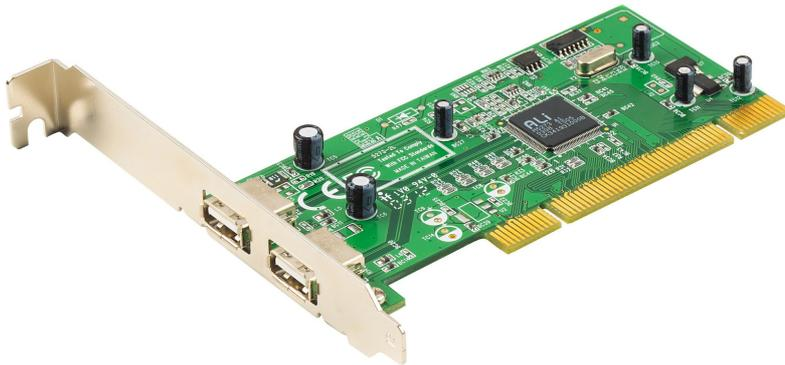
La [IC250U](#) es una tarjeta PCI con 2 puertos USB 2.0, que soporta plug&play.
