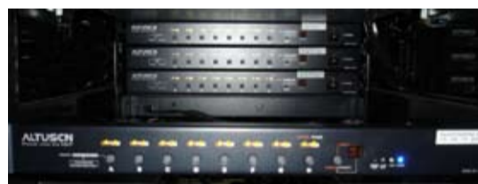
サーバーのリモート電源管理を実現する PN9108(手前)とPN0108(奥3台)
