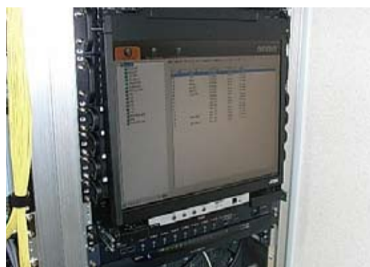
キーボード・タッチパッドパネルをラックに納めてもLCDモニターが使えるCL5800
