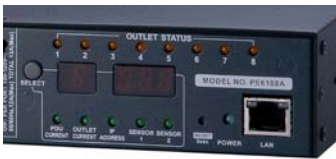
計測値は PE6108A フロントの LED パネルに表示可能
