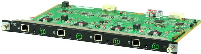
La carte d'entrée HDBaseT à 4 ports VM7514 offre une manière facile d'acheminer 4 émetteurs HDBaseT à 4 récepteurs HDBaseT, et en combinaison avec les commutateurs matriciels modulaires ATEN de fournir la capacité d'acheminer jusqu'à 32 connexions d'entrée et 32 connexions de sortie HDBaseT.
