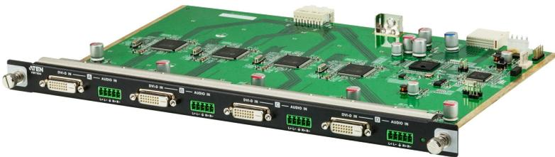
La carte d'entrée DVI à 4 ports VM7604 offre une manière facile d'acheminer n'importe quelle sources 4 audio/vidéo à un des quatre affichages, lorsqu'elle est utilisée en combinaison avec le commutateur matriciel modulaire d'ATEN.
