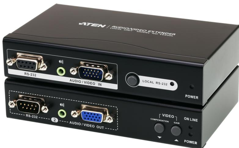
Le système d'extension audio-vidéo VE200 vous permet d'augmenter la distance qui sépare l'ordinateur du moniteur d'affichage jusqu'à 200 m pour une résolution vidéo de 1280x1024 à 60 Hz. Ceci est rendu possible par l'utilisation d'une unité émettrice locale (VE200L) et d'une unité réceptrice distante (VE200R) connectées à l'aide d'un câble à paire torsadée de catégorie 5e.
