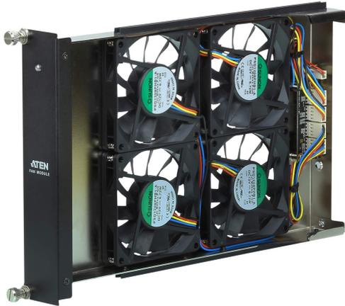
La surchauffe ralentit les performances de l'appareil de manière significative et peut entraîner une panne de l'équipement pendant son fonctionnement. Le [VM1600A](#) est équipé d'un module ventilateur qui assure qu'un système de refroidissement est en place pour empêcher à l'appareil de surchauffer. Le ventilateur est branchable à chaud et peut être facilement remplacé sans arrêter le système. ATEN garantit que votre investissement est protégé, tout en offrant des performances exceptionnelles.
