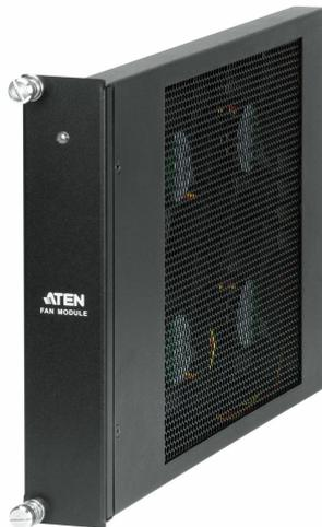
La surchauffe ralentit les performances de l'appareil de manière significative et peut entraîner une panne de l'équipement pendant son fonctionnement. Le [VM1600](#) est équipé d'un module ventilateur qui assure qu'un système de refroidissement est en place pour empêcher à l'appareil de surchauffer. Le ventilateur est branchable à chaud et peut être facilement remplacé sans arrêter le système. ATEN garantit que votre investissement est protégé, tout en offrant des performances exceptionnelles.
