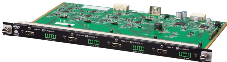
La VM7824 est une carte d'entrée HDMI True 4K qui fonctionne avec un commutateur matriciel modulaire ATEN pour offrir un moyen facile d'acheminer 4 sources audio/vidéo HDMI vers 4 affichages avec une prise en charge des images en haute définition True 4K. En plus de l'interface HDMI qui transporte les signaux A/V numériques, la VM7824 est équipée de 4 ports d'entrée audio stéréo qui permettent l'intégration audio stéréo.
