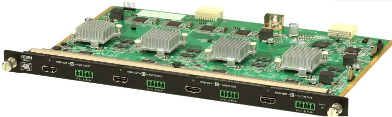
La VM8814 est une carte de sortie HDMI 4K qui fonctionne avec un commutateur matriciel modulaire ATEN pour offrir un moyen facile de router 4 sources HDMI vers 4 affichages. En plus de l'interface HDMI qui transporte les signaux A/V numériques, la VM8814 est équipée de 4 ports de sortie audio stéréo qui permettent l'extraction audio HDMI.
