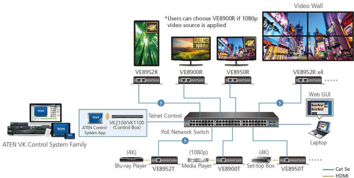
\*Remarque : Le VE8952 prend en charge le PoE et peut être installé en association avec des commutateurs réseau PoE afin de réduire le nombre de câbles d'alimentation et de prises de courant supplémentaires. Avant de choisir le commutateur réseau et l'installation, veuillez consulter le Guide d'implémentation.
