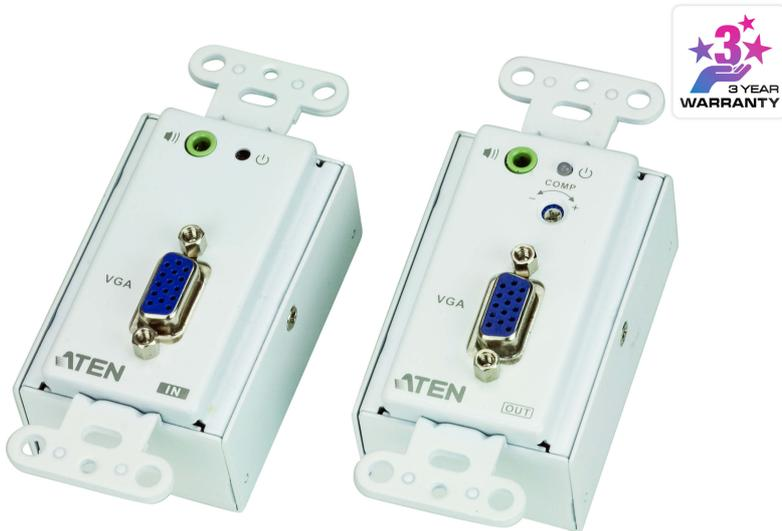
Le boîtier mural d'extension par câble de catégorie 5 VGA VE156 permet d'augmenter la distance de transmission des signaux VGA et audio jusqu'à 150 m en utilisant un câble de catégorie 5e. Il prend en charge les formats grand écran les plus populaires et assure une excellente qualité vidéo pour les transmissions longue distance. L'ensemble VE156 permet d'augmenter encore la distance ou de multiplier le nombre de sources/périphériques d'affichage.
