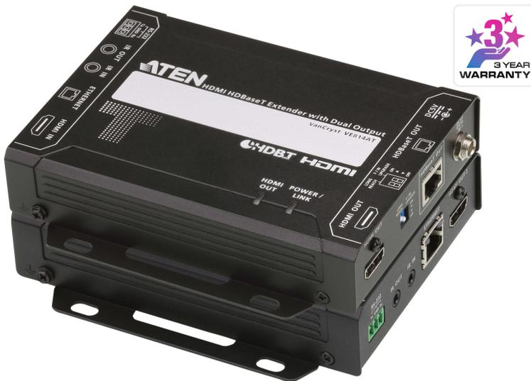
L'ATEN VE814A est un système d'extension vidéo HDBaseT pouvant transmettre les signaux HDMI jusqu'à 100 m sur un seul câble Cat 5e/6/6a ou ATEN [2L-2910](#) Cat 6. Doté de deux sorties synchrones, le VE814A peut transmettre le signal vidéo à deux affichages distants et un sur le côté local. Ce système d'extension compatible HDCP 2.2 répond aux spécifications HDMI, y compris 3D, Deep Color, au débit de données maximal de 10,2 Gbps et à la qualité vidéo 4K jusqu'à 100 m.
