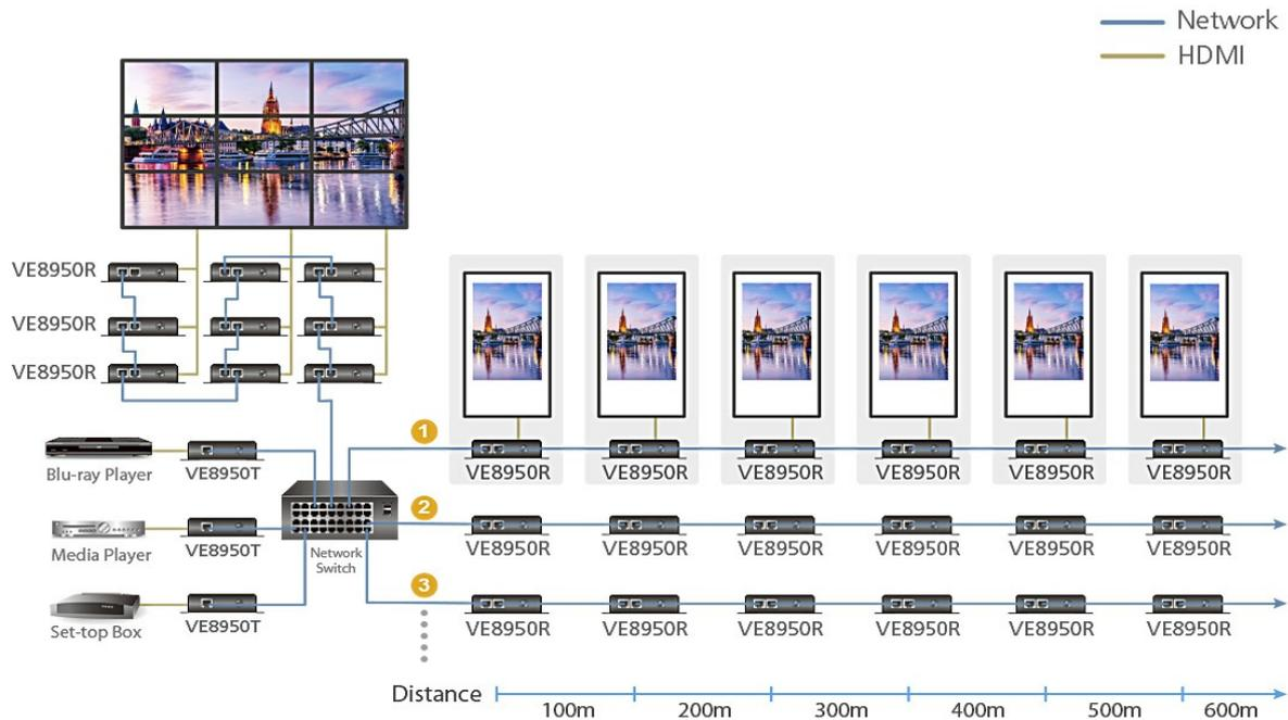
\*Utilisez des connexions en chaîne pour configurer un mur vidéo ou étendre le système audiovisuel à des centaines de mètres
