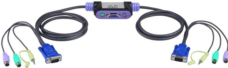
Le commutateur KVM à 2 ports CS62A présente un design extrêmement pratique avec ses câbles de 1,2 m. Il peut contrôler 2 serveurs par le biais d'une seule et même console.
