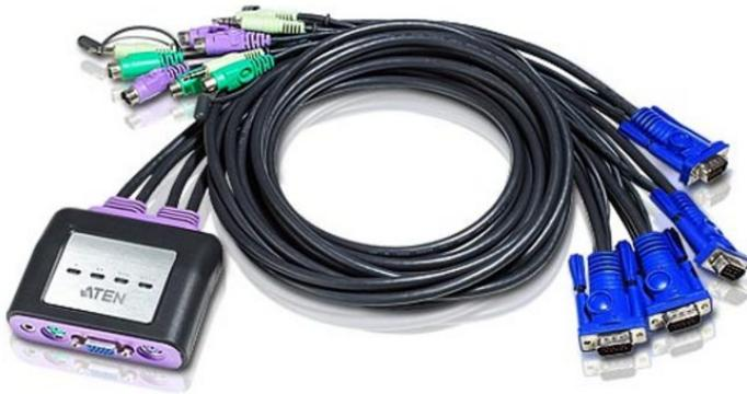
Le commutateur KVM CS64A présente un design extrêmement pratique avec ses câbles de 1,8 m et son port PS/2 intégré. Il peut contrôler 4 serveurs par le biais d'une seule et même console.
