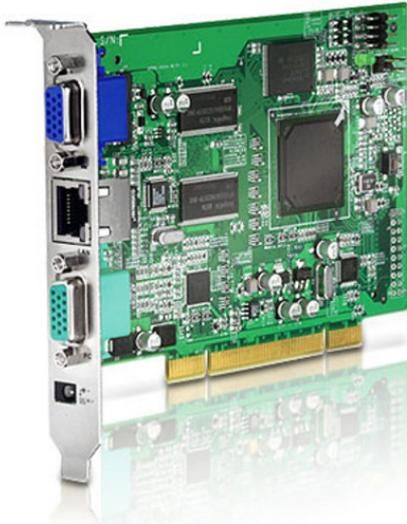
La carte PCI IP8000 combine l'accès distant au niveau BIOS sur IP, le contrôle de l'alimentation et une fonction de support virtuel. Cela fait d'elle la solution idéale pour gérer les installations distantes telles que les bornes informatiques, les systèmes de point de vente (POS) et les guichets automatiques bancaires. De plus, elle fait bénéficier de ses fonctionnalités IP aux appareils non IP (Serveurs, KVM, etc.).
