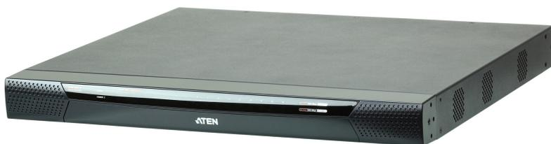
La nouvelle génération des commutateurs KVM sur IP - gamme KN d'Aten permet l'accès console locale et l'accès sur IP à distance pour que les opérateurs de surveillance et accèdent à leur centre de données complet sur un réseau en utilisant un navigateur Web. En outre, ils offrent un accès hors-bande avec la prise en charge du modem externe pour le dépannage au niveau du BIOS lorsque le réseau est en panne.
