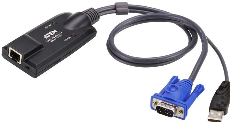
Le câble adaptateur KVM USB KA7170 permet de raccorder le commutateur KVM aux ports vidéo et USB de l'ordinateur cible. Peu encombrant et léger, il représente la nouvelle génération de câbles adaptateurs KVM USB et offre des techniques de compensation de signal et de déphasage supérieures qui garantissent une qualité vidéo améliorée.
