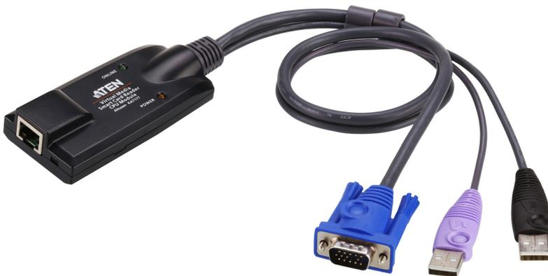
Le câble adaptateur KVM KA7177 permet de raccorder le commutateur KVM aux ports vidéo et USB de l'ordinateur cible. Le KA7177 comporte également une prise USB permettant de connecter l'ordinateur cible à un lecteur de carte à puce/CAC. Peu encombrant et léger, il représente la nouvelle génération de câbles adaptateurs KVM et offre des techniques de compensation de signal et de déphasage supérieures qui garantissent une qualité vidéo améliorée.
