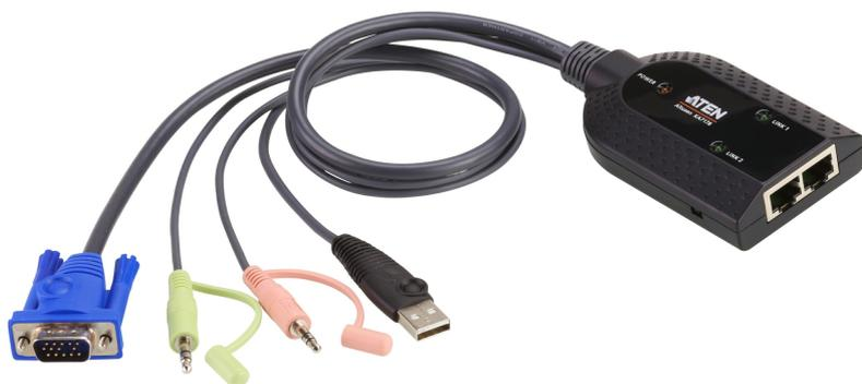
Le câble adaptateur KVM KA7178 permet de raccorder le commutateur KVM aux ports vidéo, USB et audio de l'ordinateur cible. En plus de la prise en charge des supports virtuels, il comporte deux connecteurs de catégorie 5e/6, qui permettent la connexion d'un ordinateur à deux commutateurs KVM matriciels ALTUSEN. Cela permet à des consoles sur des commutateurs différents d'accéder au même ordinateur.
