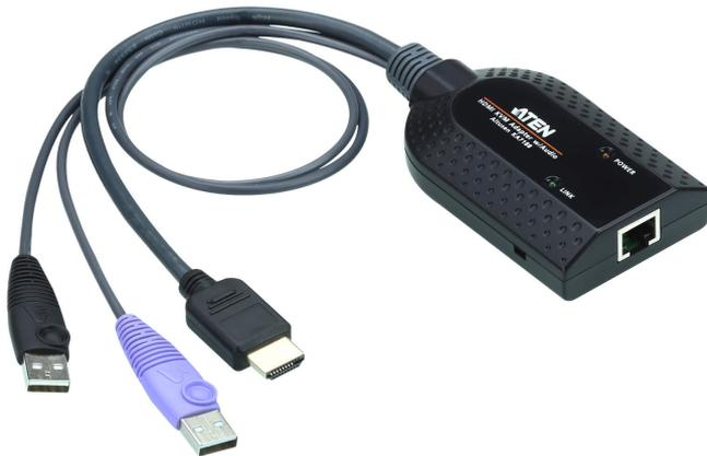
Le câble adaptateur KVM KA7188 connecte un commutateur KVM aux ports vidéo HDMI et USB d'un ordinateur cible.\* Le KA7188 prend en charge la sortie HDMI et fournit deux prises USB pour connecter un ordinateur cible aux fonctions clavier/souris, média virtuel ou Lecteur de carte à puce/CAC.\*\*
