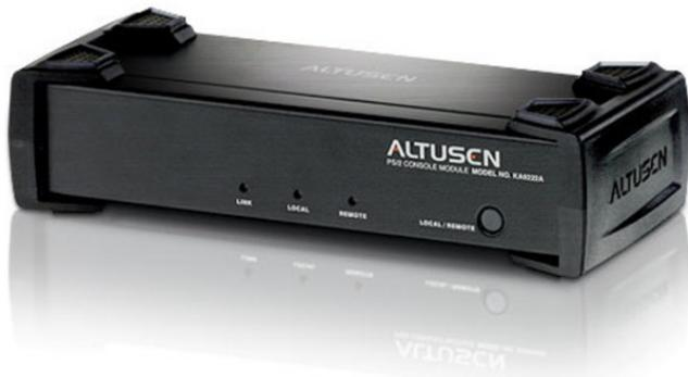
Le module KA9222A d'ALTUSEN possède une console PS/2 qui contrôle un ordinateur local et le commutateur KVM matriciel distant
