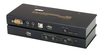
Le système d'extension KVM USB CE800B avec audio intégré permet d'accéder à un système informatique depuis une console distante (clavier et souris USB, moniteur, haut-parleurs stéréo et microphone). Il est parfait pour les usines et les sites de construction, ou pour tout type d'installation où la console doit être placée dans un endroit pratique et accessible tandis que l'équipement système sera placé dans un endroit sûr, à l'abri de la poussière et des environnements difficiles.
