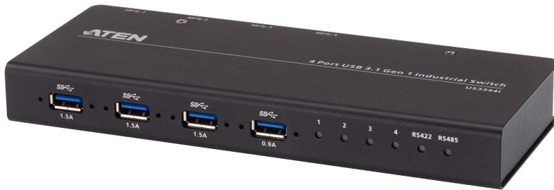
L'US3344I est un commutateur industriel USB 3.2 Gen 1 à 4 ports qui permet à quatre ordinateurs de partager et d'utiliser des appareils USB 3.2 Gen 1 tels qu'un clavier, une souris et d'autres périphériques. Les utilisateurs peuvent se concentrer manuellement sur un ordinateur particulier à l'aide du bouton du commutateur, ou automatiquement sur la détection des ordinateurs connectés.
