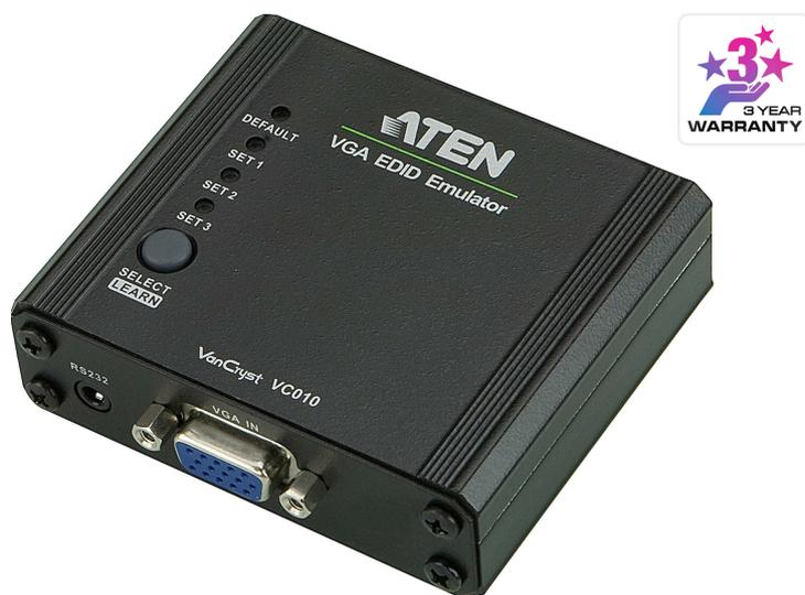
L'ATEN VC010 è un emulatore VGA EDID progettato per emulare e memorizzare l'EDID di uno schermo e fornire dati EDID costanti e affidabili per un dispositivo VGA sorgente in modo da ottimizzare in maniera efficiente la risoluzione video.
