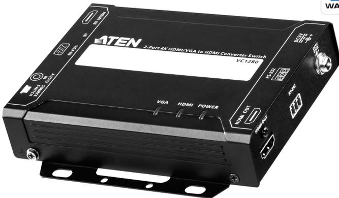
L'ATEN VC1280 è un dispositivo facile da usare che rende più semplice il collegamento delle sorgenti HDMI e VGA a uno schermo HDMI o proiettore. Oltre a essere conforme con HDCP 1.4, il VC1280 supporta anche HDMI 1.4, tra cui 3D, Deep Color e 4K (3840 x 2160 a 30 Hz). Inoltre, il VC1280 dispone di conversione VGA integrata che consente di trasmettere i segnali VGA all'uscita HDMI senza l'uso di ulteriori adattatori o scaler.
