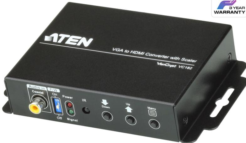
Il convertitore da VGA a HDMI VC182 con scaler offre un modo semplice e comodo per convertire i segnali d'ingresso VGA in video digitale (HDMI). Il VC182 è dotato di un motore di ridimensionamento ad alte prestazioni che converte la risoluzione video per produrre immagini della miglior qualità.
