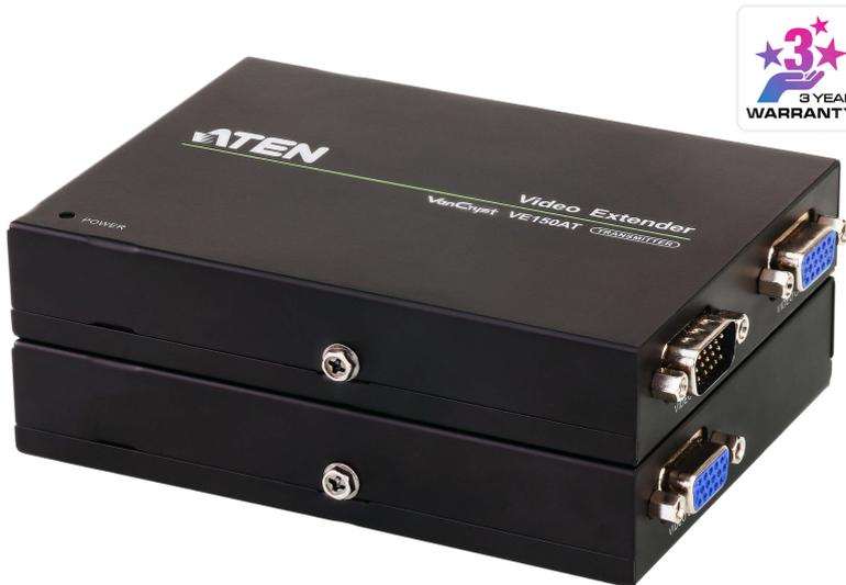
L'extender video VE150A è costituito da un'unità locale trasmittente e da un'unità remota ricevente connesse tra loro da cavi Cat5e standard. La distanza massima tra le unità è di 150m. Si tratta di una soluzione ideale per fabbriche e cantieri o altri luoghi dove lo schermo può essere esposto a rischi mentre si desidera mantenere il sistema al sicuro.
