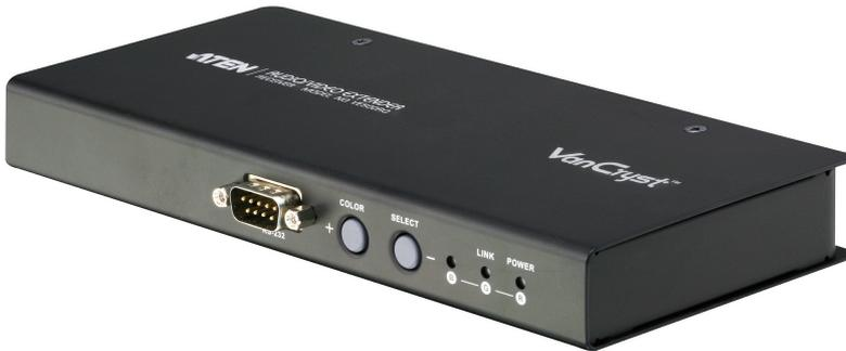
Il ricevitore A/V Over Cat 5 [VE500R](#) è stato progettato esclusivamente per essere integrato in modo semplice al Matrix Switch [VM0808T/VM1616T](#) ATEN per ampliare i segnali fino a 300 m dallo switch ad un display con un cavo Cat 5e. Il [VE500](#) è ideale per installazioni, come cantieri, pavimenti delle fabbriche e centri di controllo e di sicurezza, in cui l'apparecchiatura del sistema può trovarsi in un luogo sicuro e protetto, mentre il display è alla vista del pubblico.
