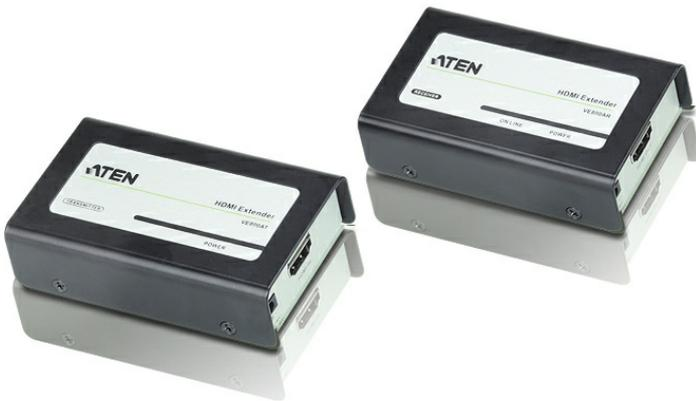
L'estensore HDMI VE800A aumenta la distanza tra lo schermo HDMI e la sorgente HDMI fino a 60 m utilizzando un cavo Cat 5e. VE800A di ATEN integra una nuova tecnologia che consente la trasmissione dei segnali A/V su un singolo cavo Cat 5e. La porta DDC in dotazione consente di usare l'EDID dello schermo semplicemente collegando un altro cavo Cat 5e. VE800A supporta le funzioni HDMI come 3D e Deep Color per offrire un'esperienza di visualizzazione perfetta delle immagini.
