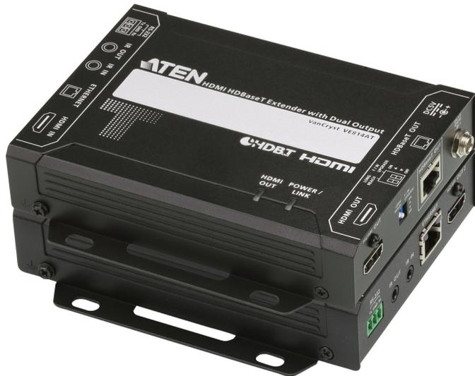
La nuova offerta di ATEN fornisce video in alta qualità su doppi schermi a distanza. Con l'extender HDMI VE814, i tuoi schermi HDMI possono essere situati fino a 100 metri distanti dal dispositivo sorgente HDMI. Questo è possibile usando un solo cavo Cat 5e/6, che è economico e facilmente disponibile. In aggiunta, il tuo video può essere trasmesso usando fino a tre schermi HDMI – i doppi schermi connessi alla unità ricevente (VE814R) e un altro alla unità trasmittente (VE814T).
