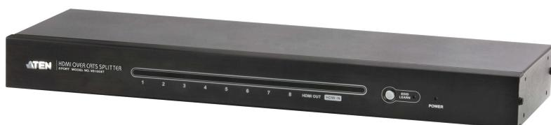
Lo Splitter HDMI VS1808T su Cat 5 è uno splitter studiato per la connessione di una sorgente a 8 schermi a lunga distanza. Integrando i ricevitori compatibili consigliati\*, lo Splitter HDMI VS1808T su Cat 5 può rappresentare una soluzione completa ideale per qualsiasi installazione A/V professionale che richiede la trasmissione dei contenuti multimediali su diverse destinazioni posizionate a circa 60 m dalla sorgente.
