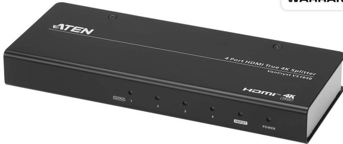
Lo splitter HDMI 4K reale VS184B è la soluzione perfetta per tutti quelli che desiderano inviare una sorgente video digitale ad alta definizione a quattro schermi contemporaneamente. Supporta tutte le apparecchiature dotate di HDMI, ad esempio lettori DVD, decoder satellitari e tutti i monitor, schermi, proiettore o TV HDMI.
