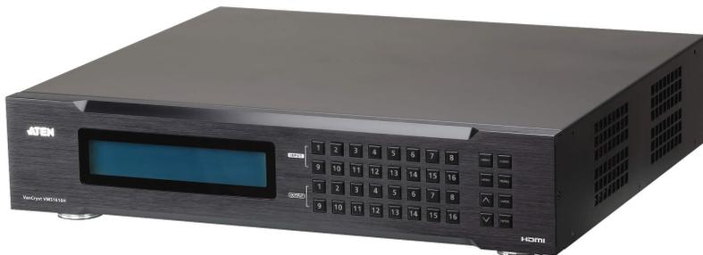
Il VM51616H è uno switch matrix HDMI 16 x 16 che offre un modo semplice e comodo per indirizzare una delle 16 sorgenti audio e video HDMI su 16 schermi HDMI, con una visualizzazione rapida di tutte le porte di collegamento tramite LCD del pannello frontale o uscita HDMI locale per l'anteprima di più sorgenti.
