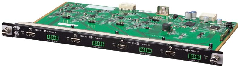
Il VM7824 è una scheda ingresso True 4K HDMI che funziona con lo Switch matrix modulare di ATEN per offrire un modo semplice di indirizzare 4 sorgenti audio/video HDMI su 4 schermi con supporto per immagini True 4K ad alta definizione. Oltre all'interfaccia HDMI che gestisce i segnali A/V digitali, il VM7824 offre anche 4 porte di ingresso audio stereo che consente l'integrazione dell'audio stereo.
