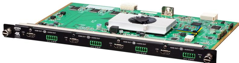
Il VM8824 è una scheda uscita True 4K HDMI che funziona con lo Switch matrix modulare di ATEN per offrire un modo semplice di indirizzare 4 sorgenti audio/video analogiche/digitali su 4 schermi HDMI con supporto per immagini True 4K ad alta definizione. Oltre all'interfaccia HDMI che gestisce il segnale A/V digitale, il VM8824 offre anche 4 porte uscita audio stereo che consentono l'estrazione dell'audio HDMI.
