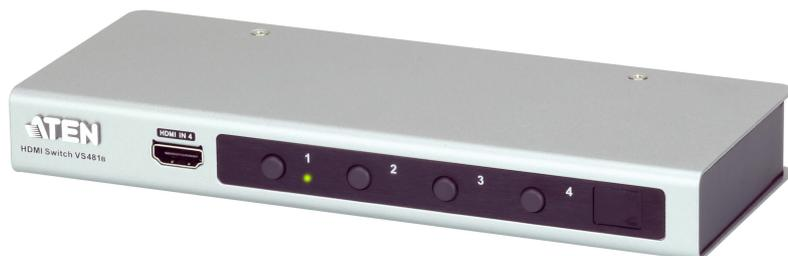
Lo Switch HDMI a 4 porte VS481B consente di collegare rapidamente 4 sorgenti HDMI a uno schermo HDMI e passare in modo semplice da l'uno all'altro tramite il pulsanti push sul pannello anteriore, RS-232 o telecomando IR. I LED del pannello anteriore indicano il dispositivo sorgente selezionato per la visualizzazione.
