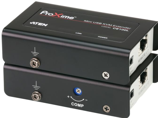
L'extender KVM USB CE100 con qualità video superiore e protezione ESD incorporata consente l'accesso a un sistema informatico da una console USB remota (tastiera e mouse USB, monitor). Il CE100 migliora i design precedenti: 1) incorporando una funzione di regolazione della compensazione sull'unità remota per una qualità video migliore; 2) utilizzando degli economici cavi Cat 5e al posto di cavi standard, ingombranti e cari, per fornire un collegamento dati più affidabile, comodo e stabile.
