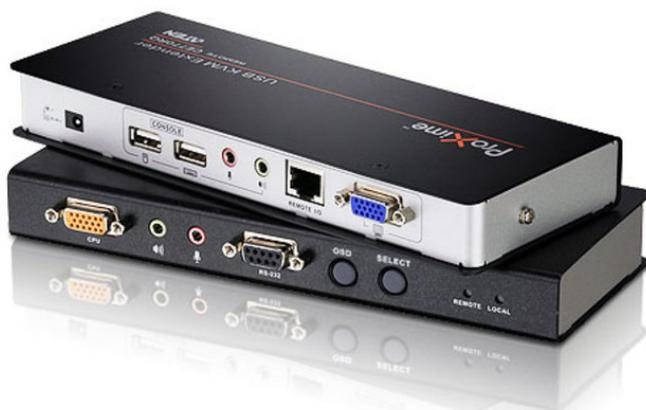
Il CE790 è un extender KVM basato su IP con rilevamento automatico dei cavi (Auto-MDIX) e funzionalità RS-232 che consente di accedere a un sistema informatico da una console USB remota (monitor, mouse e tastiera USB) ovunque su una intranet.
