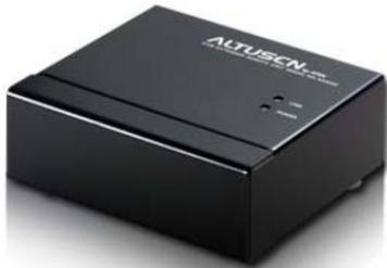
Il modulo extender KVM KA9250 consente all'utente della console KVM (tastiera, video, mouse) di gestire i server in un'installazione switch KVM [KH0116](#) con alta densità di porte fino a 150m di distanza. Il modulo KA9250 si connette alla porta RJ-45 della console remota [KH0116](#) tramite un cavo standard Cat 5 per un'installazione semplice e affidabile. In caso di presenza di console sia locale sia remota, entrambe possono accedere allo switch KVM.
