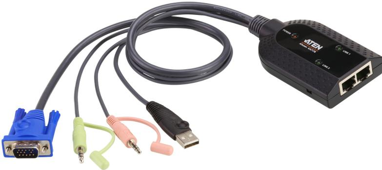
Il cavo adattatore KVM KA7178 collega lo switch KVM alla porta video, alle porte USB e audio del computer di destinazione. Oltre al supporto Virtual Media, dispone anche di due connettori Cat 5e/6 per il collegamento del computer a due switch KVM Matrix ALTUSEN. In questo modo, le console su switch diversi accedono allo stesso computer.
