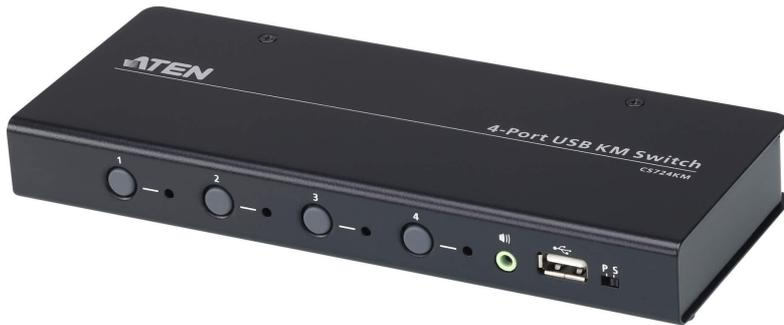
Il CS724KM è uno switch KM USB a 4 porte che consente agli utenti di controllare fino a 4 computer con una singola tastiera e mouse. È possibile collegare a margherita due switch per consentire il controllo di fino a 8 computer da una singola console.
