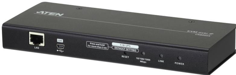
La nuova generazione di ATEN CN8000A dispone di una qualità video superiore con risoluzioni HD fino a 1920 x 1200, LUC (Laptop USB Console) per rendere più semplice l'accesso al KVM, OSD della console locale facile da usare e funzione virtual media senza cavo aggiuntivo.
