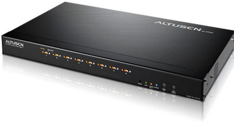
Il KN9108 è uno switch KVM a 8 porte in un alloggiamento 1U per un comodo montaggio in rack. Il dispositivo consente agli amministratori di sistema di accedere ai server collegati sia in locale sia via IP (LAN e/o WAN). Gli speciali cavi KVM assicurano sempre una risoluzione video ottimale.
