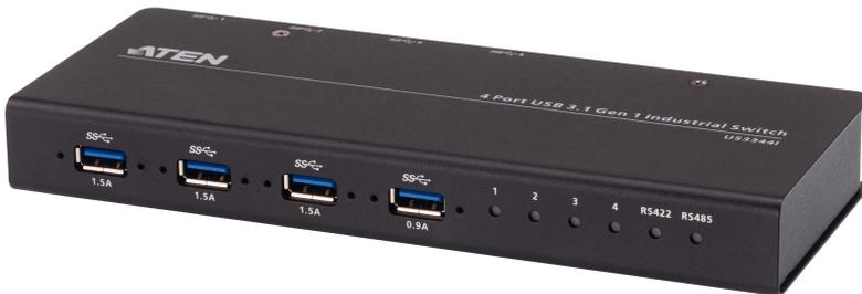
L'US3344I è uno switch industriale a 4 porte USB 3.2 Gen 1 che permette a quattro computer di condividere e utilizzare dispositivi USB 3.2 Gen 1 come tastiera, mouse e altre periferiche. Gli utenti possono commutare manualmente il focus su un particolare computer usando il pulsante sullo switch, o commutare il focus automaticamente in base al rilevamento dei computer collegati.
